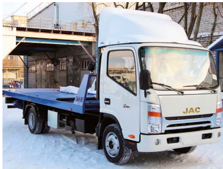
▲ Эвакуатор со сдвижной платформой на шасси JAC N75, «Смартэко»
