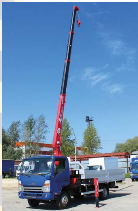
▲ Бортовой автомобиль с КМУ Unic на шасси JAC N75, AM3
