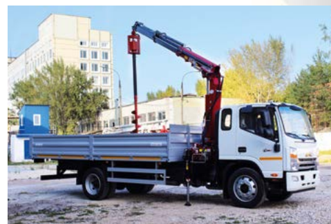
▲ Бортовой автомобиль с КМУ Чайка-Атсco Veba 811Т и буром на шасси JAC N120, «Чайка-Сервис»
