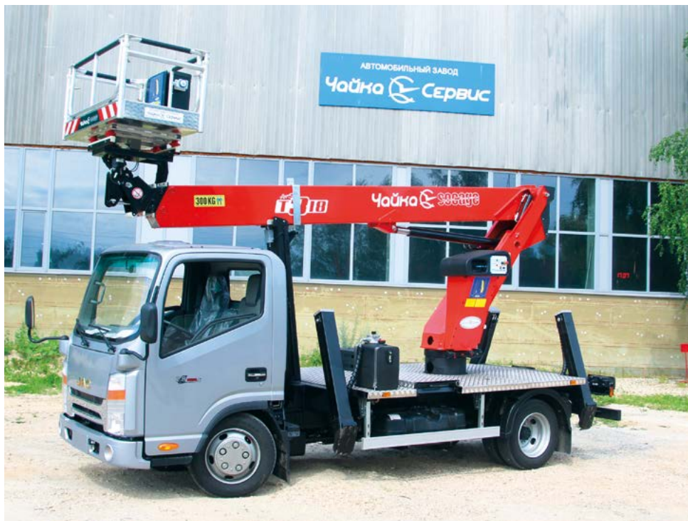
▲ АГП Чайка-Sosage T318 с передним расположением люльки на шасси JAC N56, «Чайка-Сервис»
