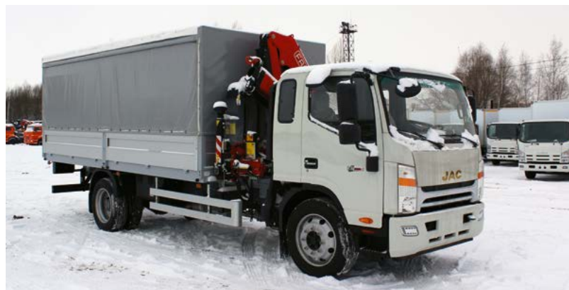
▲ Тентованный бортовой автомобиль с КМУ Fassi на шасси JAC N120, AM3
