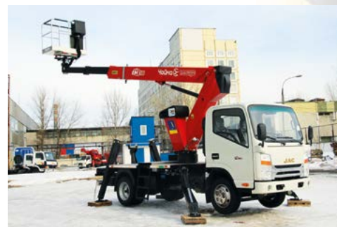
▲ АГП Чайка-Sosage T318 с задним расположением люльки на шасси JAC N56, «Чайка-Сервис»
